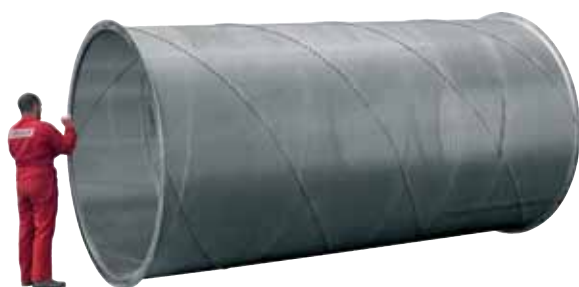
Tambour à filtration "intérieur/extérieur" alimentation interne.
